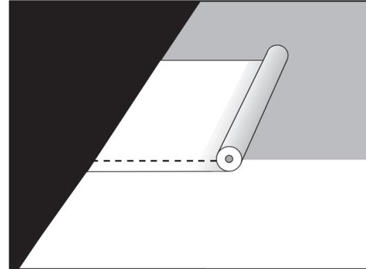
Overlap de banen van het VMZINC Membrane met 15cm (volg de fijne stippelijijn). Verkleef de banen steeds onderling met de geïntegreerde zelfklevende band.
