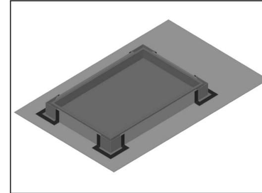
Om waterinfiltraties te voorkomen rond een dakdoorboring, voorzie het geheel van de doorboring van een voldoende opstand in het VMZINC Membrane en kleef het geheel van de opstanden vast door middel van de zelfklevende band van DuPont™ Tyvek™. Besteed hierbij zorgvuldig aandacht aan het verwerken de hoeken.
